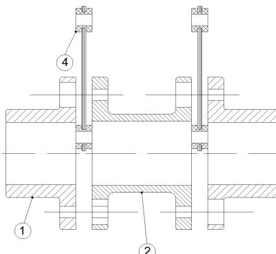
**C)** Montare i nuovi pacchi lamellari (4) e fissarli con la viteria nuova fornita in maniera alternata, come in figura 3.
